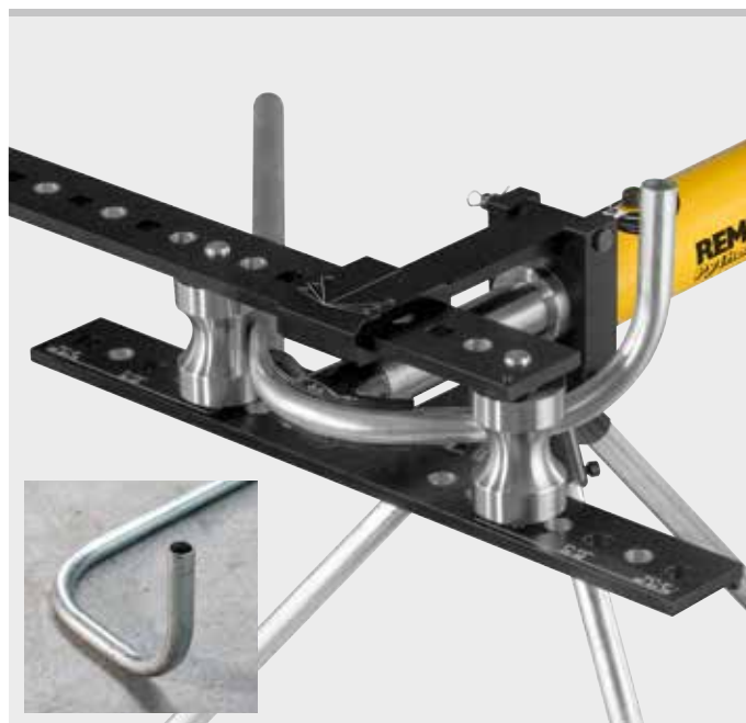
Для изготовления этажных изгибов на нескольких уровнях.
